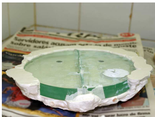
Fig. 4.17: Bloco a ser desbastado. O fundo do espelho está virado para cima.
