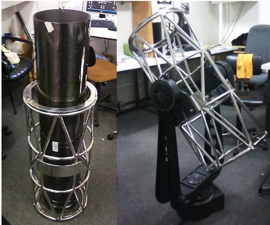
Fig. 5.66: Tubo de fibra carbono dentro do seu suporte e suporte preso à montagem.
