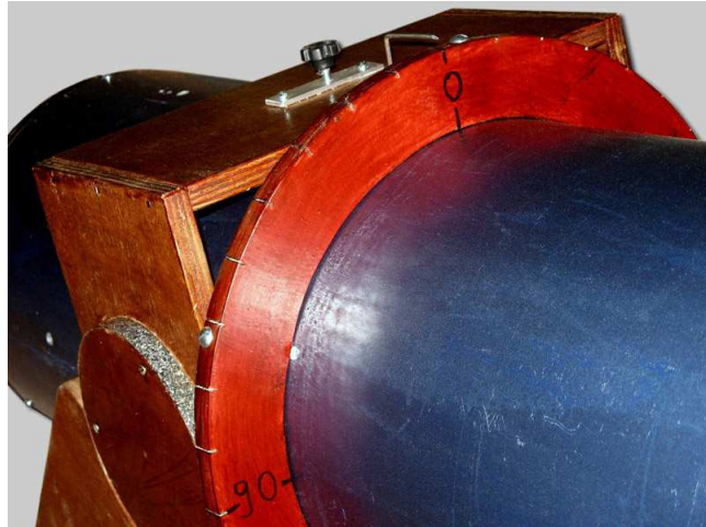
Fig. 3.23: Detalhe da escala graduada fixada ao tubo do instrumento.
