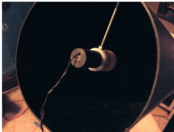
Fig. 3.18: Detalhe da entrada do tubo do instrumento. A fonte laser para o alinhamento pode ser vista encaixada no suporte montado para câmera CCD.
