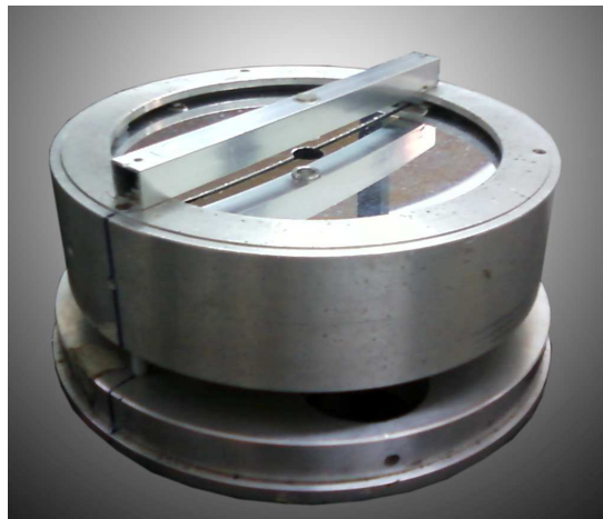
Fig. A-I.2: Suporte do cilindro sobre o protótipo do espelho heliométrico. A abertura central entre os hemisférios permite que o cilindro seja iluminado.
