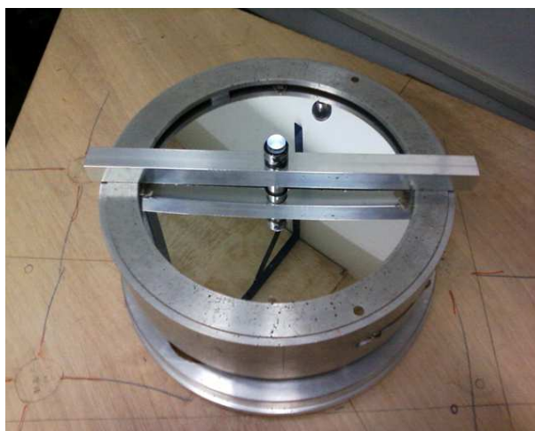
Fig. 4.52: Espelho heliométrico sobre a bancada de teste. A superfície do cilindro de vidro brilha, iluminada posteriormente por um led.
