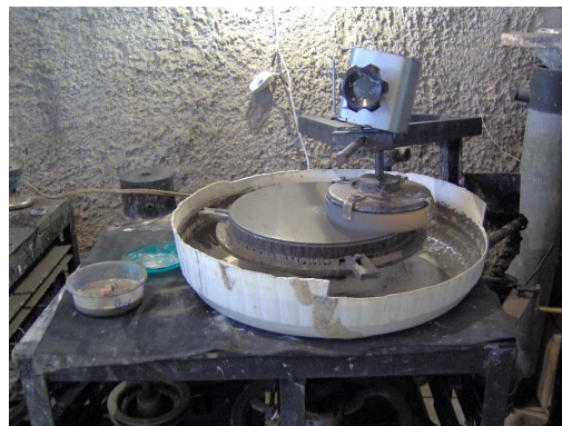
Fig. A-III.2: Disco de CCZ-HS preso à máquina de desbaste/polimento.
