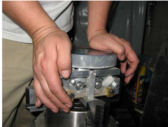
Fig. 5.13: Espelho sendo pressionado contra o piche viscoso.
