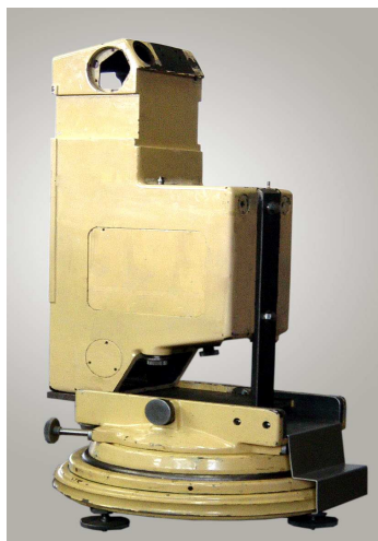
Fig. 2.8: Corpo do Astrolábio Danjon sendo adaptado em um heliômetro.
