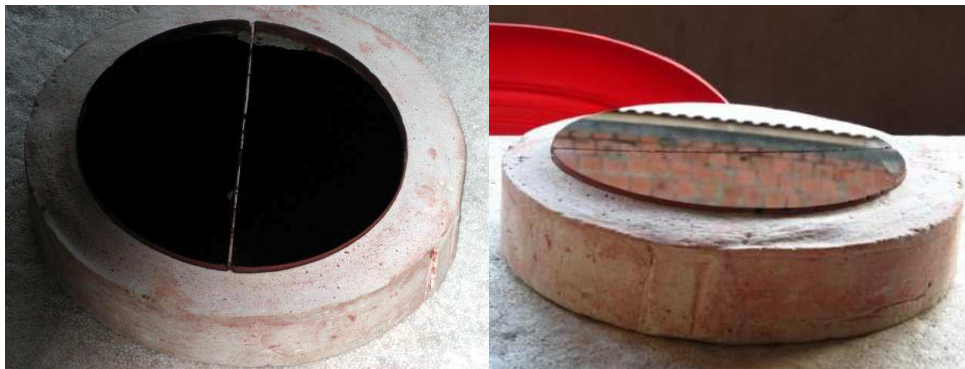
Fig. 3.9: Espelho em sua forma, já polido.
