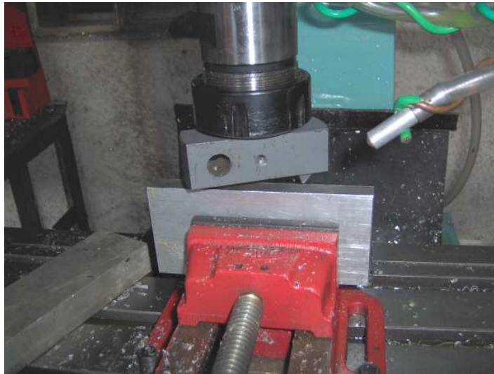
Fig. A-IV.4: Acabamento das peças pré-cortadas usando uma fresa de um corte só.
