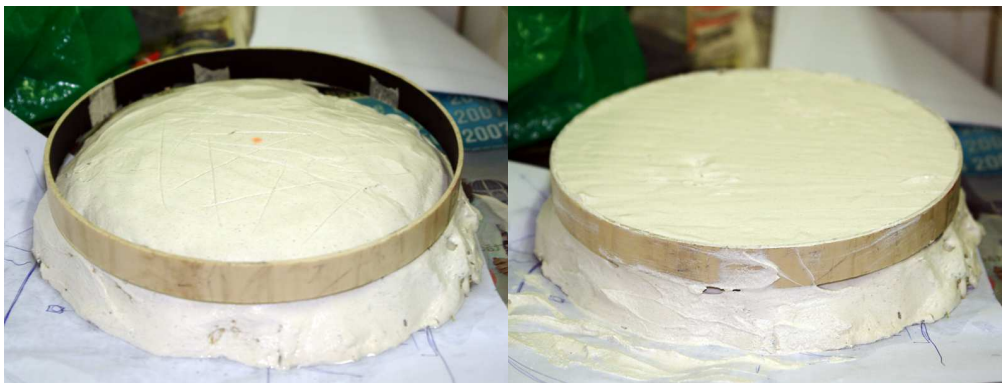
Fig. 4.21: Ajuste do bloco para servir de base para a ferramenta.
