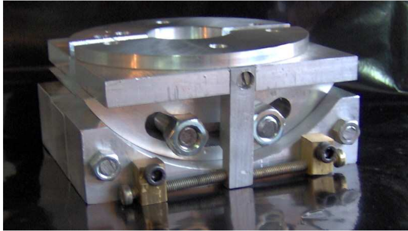
Fig. A-IV.18: Vista dos parafusos de ajuste do ângulo de inclinação da mesa.
