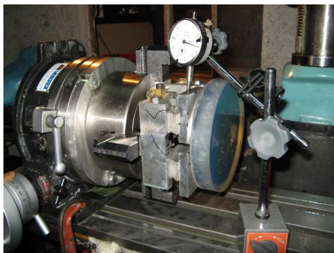
Fig. 5.16: Relógio comparador para ajuste antes do corte.
