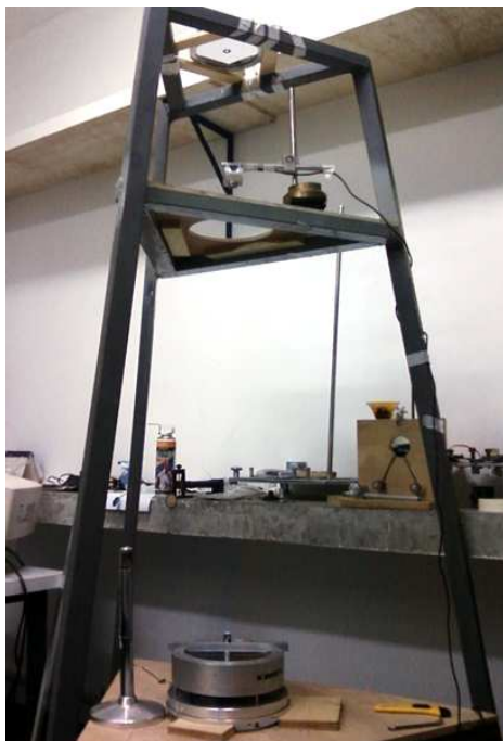
Fig. 4.53: Montagem experimental para o desenvolvimento do teste de auto-colimação.
