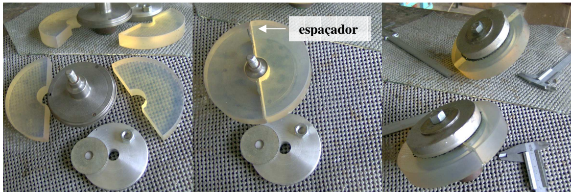
Fig. 5.32: Seqüência de fixação dos espelhos.
