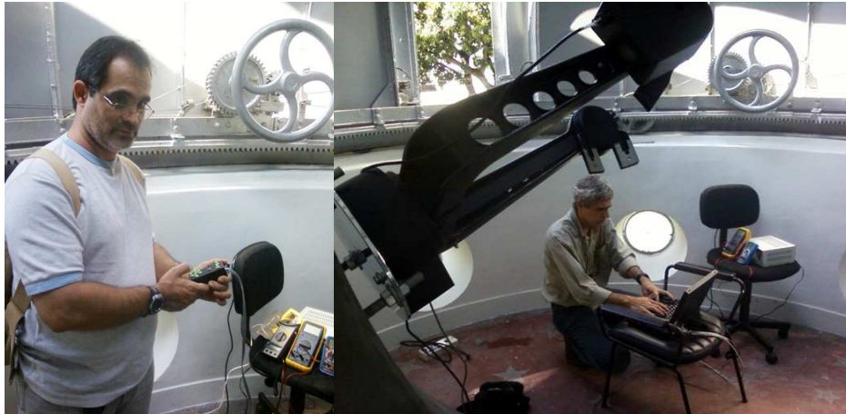
Fig. 5.75: Implementação do sistema de controle manual e automático da montagem.
