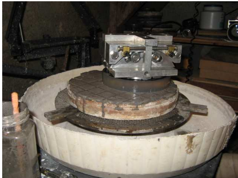
Fig. 5.28: Conjunto hemi-espelhos/mesa sobre a base de desbaste fino.
