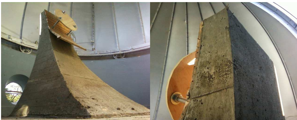
Fig. A-II.11: Superfície do concreto após a cura.
