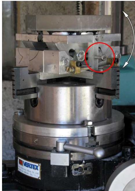
Fig. 5.24: O círculo indica o novo parafuso de ajuste acrescentado à mesa. A seta curva indica o movimento transversal que montagem passou a fazer.
