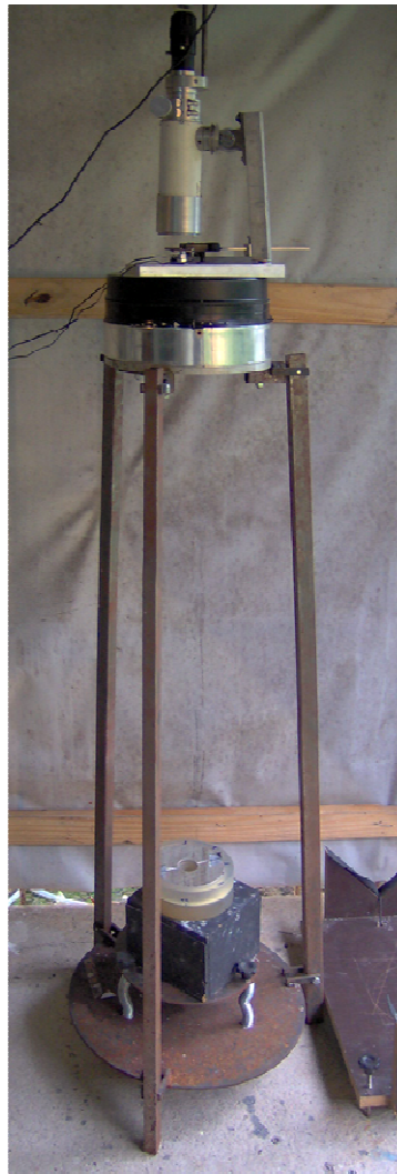
Fig. 5.42: Instalação instrumental completamente montada. Parafusos na base de apoio do espelho podiam ser ajustados para deixar o espelho na horizontal.
