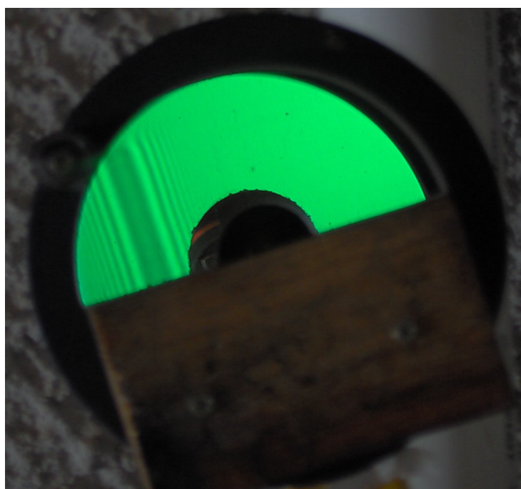
Fig. A-V.15: Teste de wire ortogonal ao corte, em um dos hemi-espelhos.
