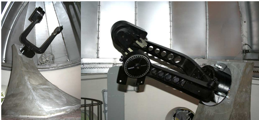
Fig. A-II.13: Montagem equatorial de garfo em seu pilar definitivo.
