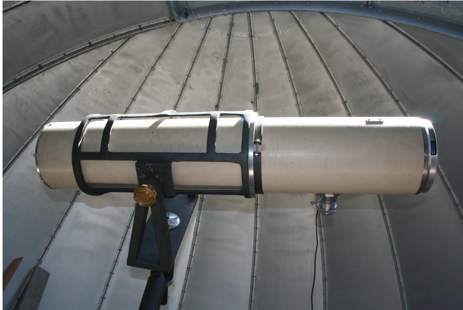
Fig. 4.64: Heliômetro de testes posicionado dentro do suporte.
