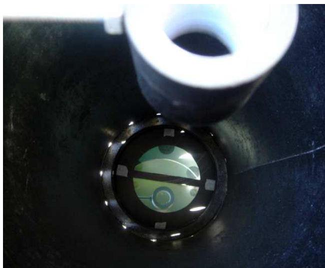
Fig. 3.25: Vista da parte interna do tubo do instrumento onde se vê o espelho partido, com sua máscara, refletindo o suporte da câmera.
