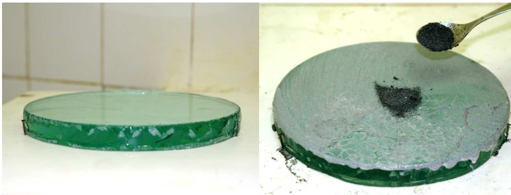
Fig. 4.18: Detalhe da ferramenta fixada e do abrasivo em pó depositado em sua superfície.
