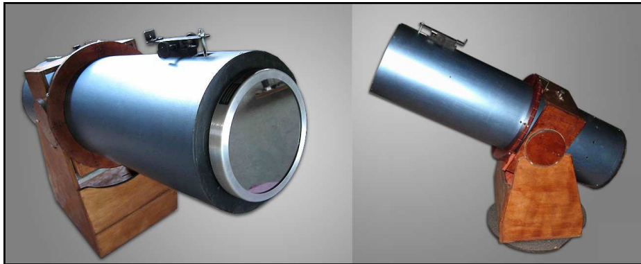
Fig. 3.24: Vistas da montagem do protótipo. À esquerda, um filtro solar Thousand Oaks pode ser visto fixado à boca do tubo do instrumento.
