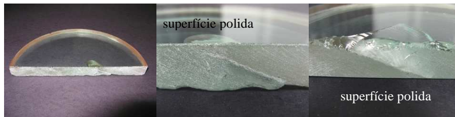
Fig. 4.1: Composição mostrando a metade do espelho cortado e o detalhe da trinca, que não chegou à superfície polida.
