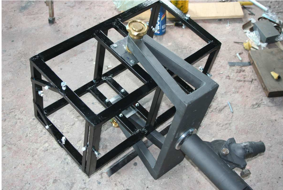
Fig. 4.68: Novo suporte do tubo encaixado no garfo da montagem.
