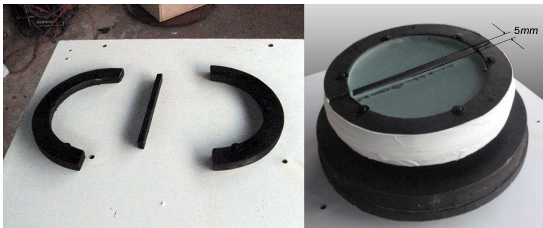
Fig. 3.16: Detalhe das peças de suporte dos hemi-espelhos e da montagem completa da célula.
