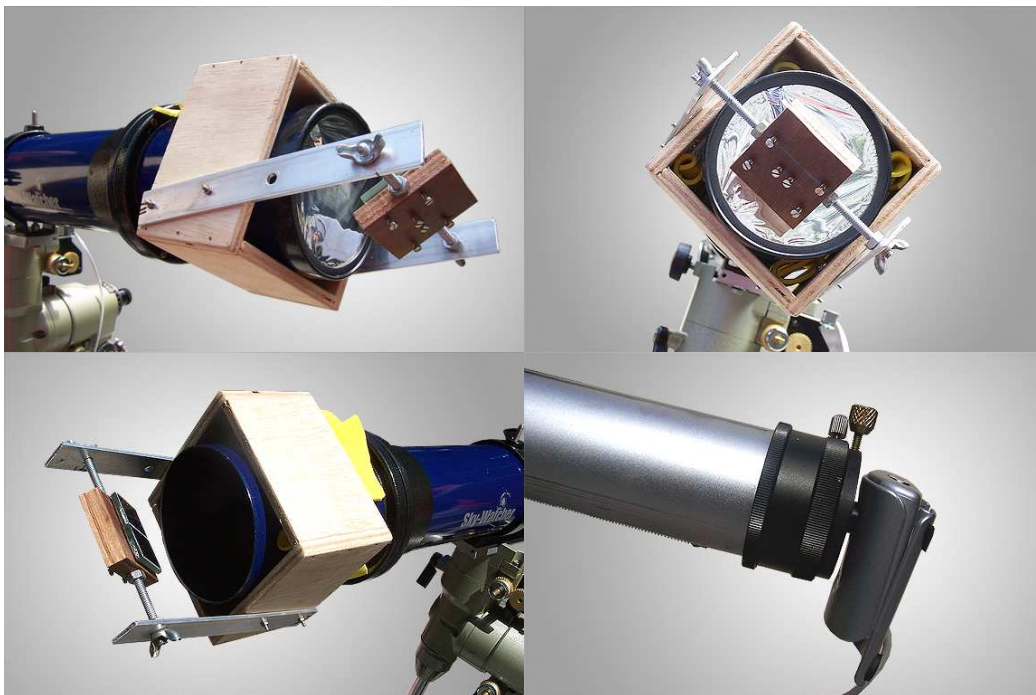
Fig. 3.5: Detalhe da montagem dos espelhos duplicadores, do filtro solar e da WebCam.
