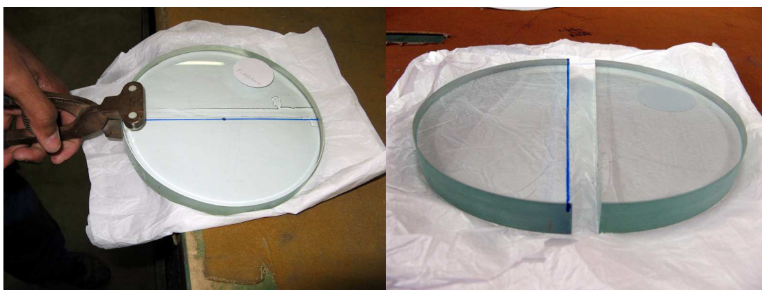
Fig. 4.7: Corte do espelho.
