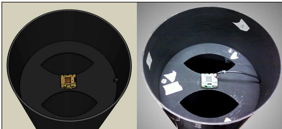
Fig. 5.70: Comparação entre o projeto do suporte no interior do tubo e sua efetiva montagem.
