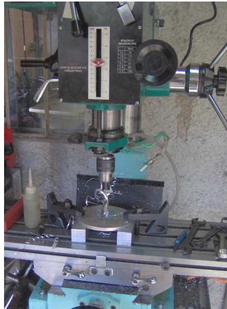
Fig. A-IV.2: Furo inicial de 20mm.
