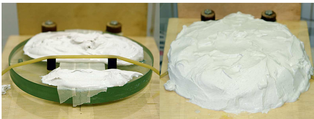
Fig. 4.16: Engessamento do espelho.
