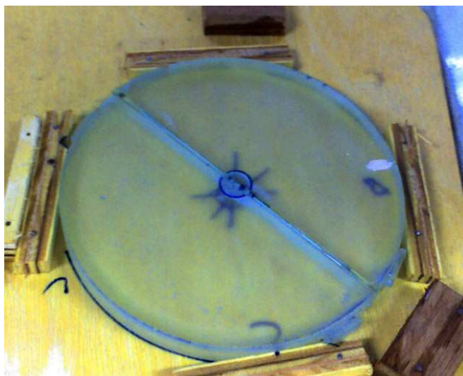
Fig. 4.51: Espelho Heliométrico, fixado a uma base de madeira, pronto para ser furado.
