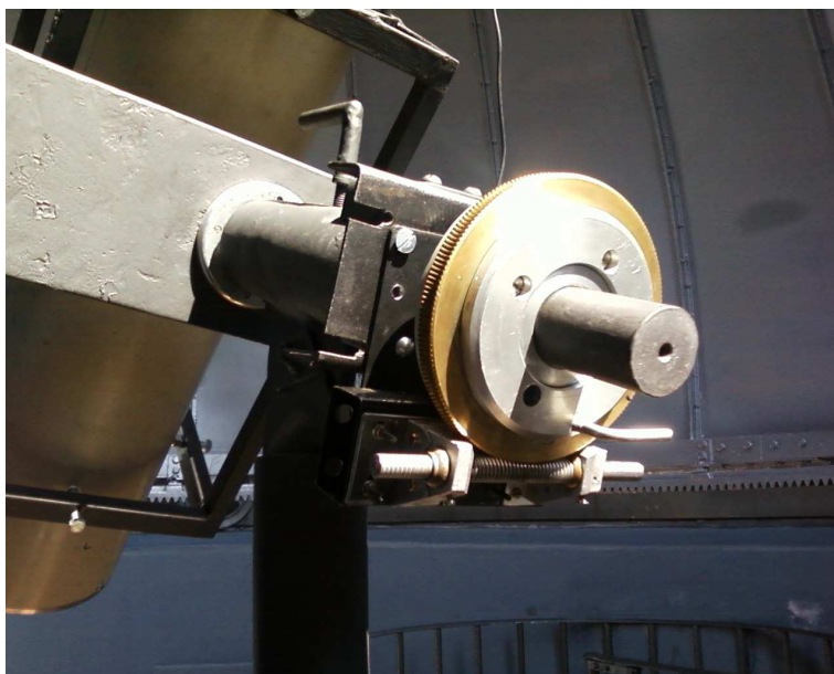
Fig. 4.72: Peça para ajuste fino do movimento em ascensão reta da montagem.
