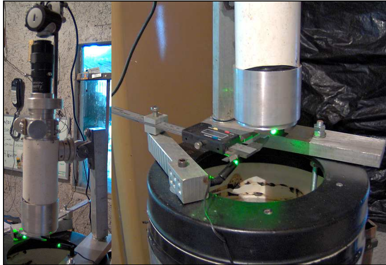
Fig. 5.41: Detalhes da montagem instrumental, mostrando o paquímetro, os leds de iluminação, a luneta e a webcam.
