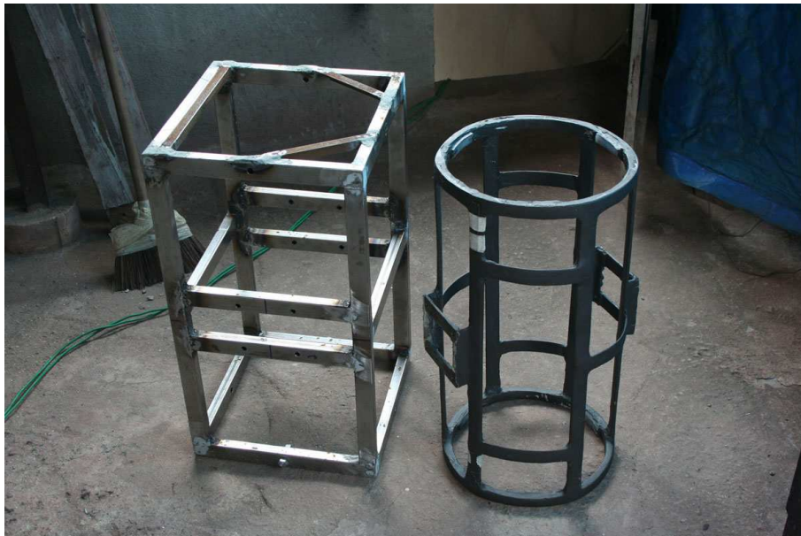
Fig. 4.67: Novo suporte do tubo ao lado do antigo.
