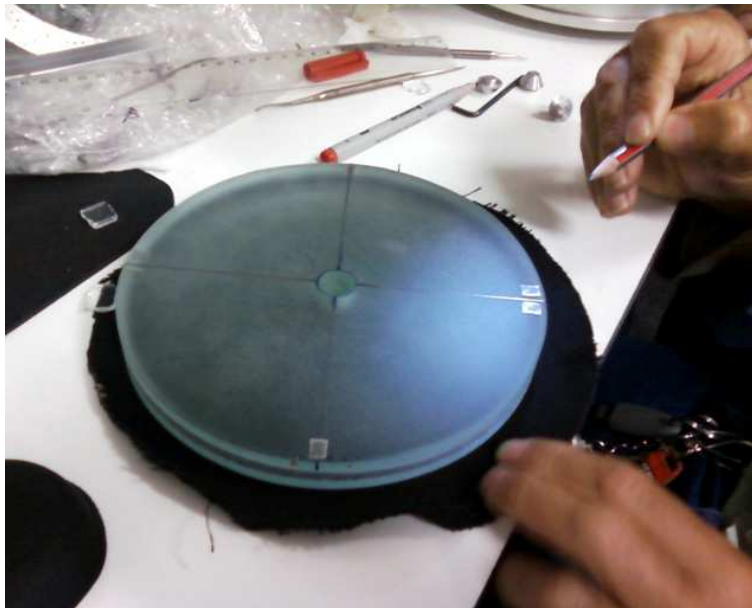
Fig. 4.43: Calços dos hemi-espelhos sendo colocados sobre a base.
