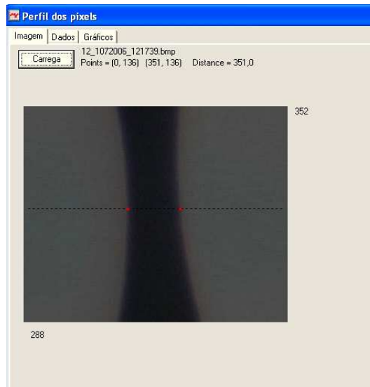
Fig. 6.5: Imagem dupla do disco solar, mostrando a linha que está sendo analisada (linha 136). Os pontos vermelhos mostram as coordenadas para os bordos nesta linha.
