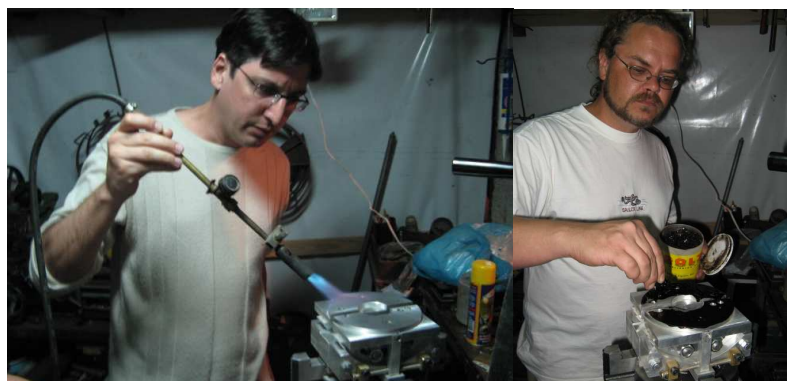
Fig. 5.12: Mesa sendo aquecida para a aplicação do piche.
