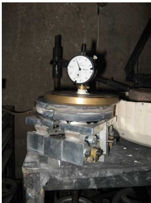
Fig. 5.29: Medição com um esferômetro após cada sessão de desbaste fino.
