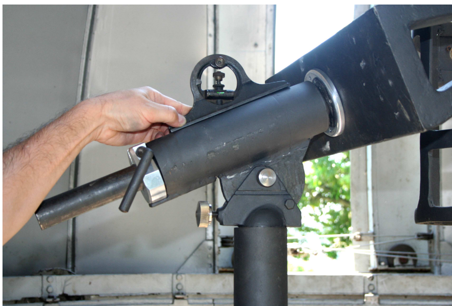
Fig. 4.63: Ajuste do eixo polar da montagem equatorial.
