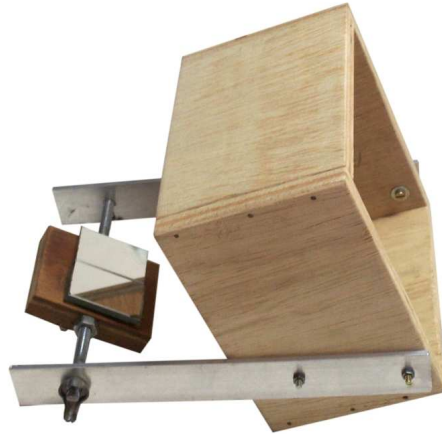
Fig. 3.4: Detalhes da montagem dos espelhos duplicadores.
