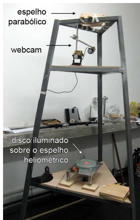
Fig. 4.48: Primeira montagem experimental do teste de colimação do Heliômetro.
