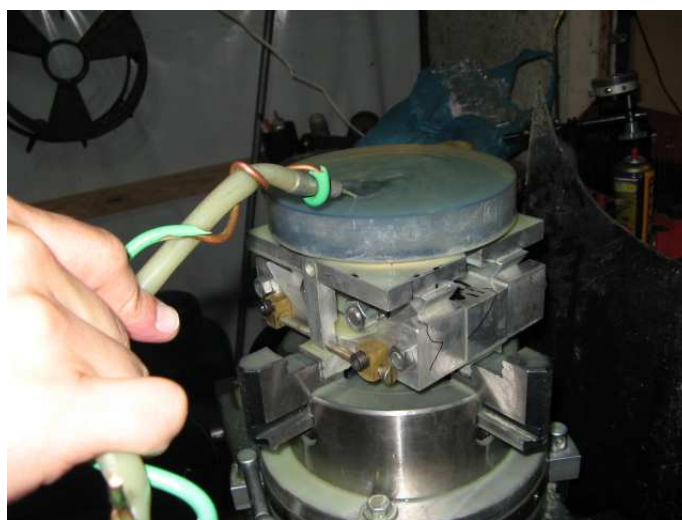
Fig. 5.15: Esfriando o conjunto com líquido refrigerante.
