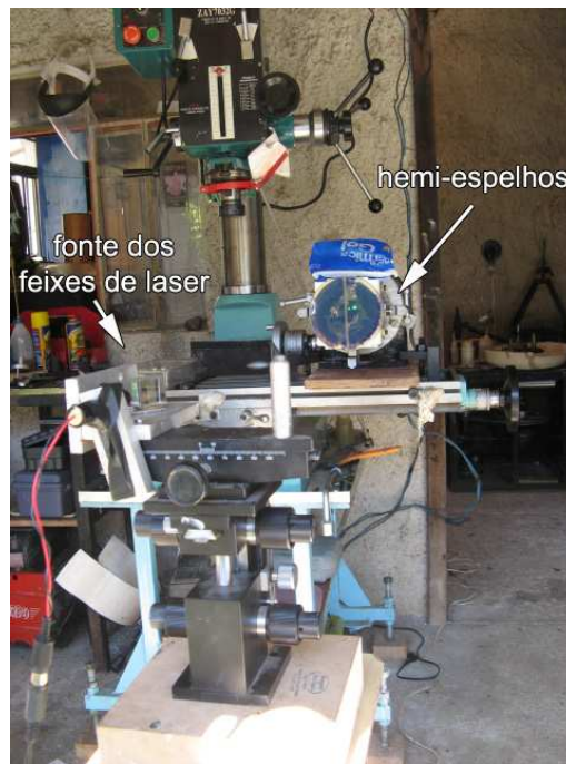
Fig. 5.21: Montagem instrumental para a criação do diedro. Na imagem se vê a fonte dos feixes posicionada em frente aos hemi-espelhos presos à mesa especial.
