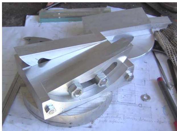
Fig. A-IV.15: Peças aparafusadas. Os parafusos de travamento já estão no seu lugar.
