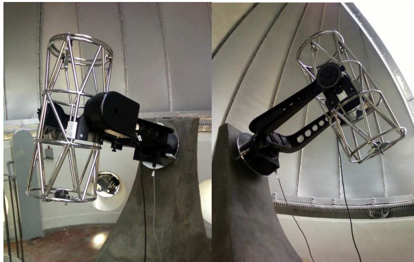
Fig. 5.76: Suporte do tubo fixado à montagem.
