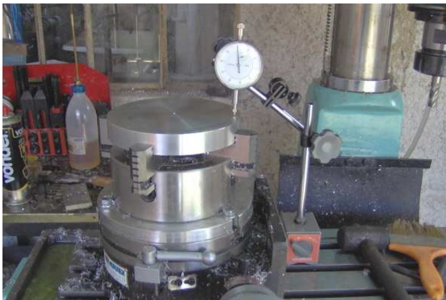
Fig. A-IV.5: Disco de alumínio preso à mesa divisora.
