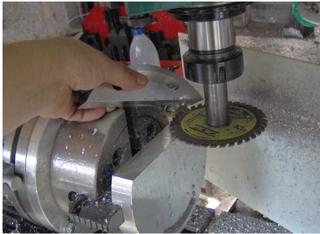
Fig. A-IV.11: Primeira peça convexa cortada.
