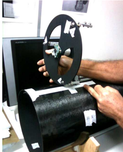
Fig. 5.69: Estudo do posicionamento da placa-aranha dentro do tubo.
