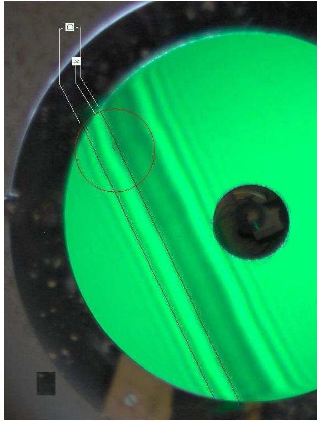
Fig. A-V.13: Exemplo de imagem do teste de wire em um espelho com defeito em sua superfície.
