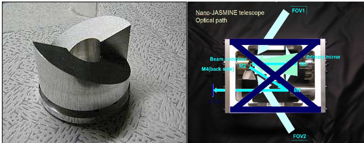
Fig. 2.19: À esquerda, os espelhos planos em diedro do satélite Nano-JASMINE. À direita, o caminho óptico do telescópio (JASMINE team, 2009).
