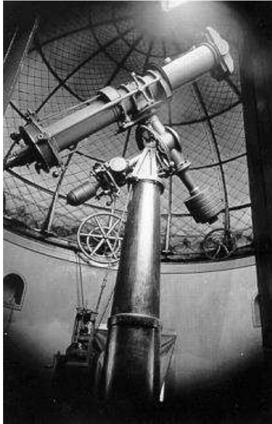
Fig. 2.16: Heliômetro de Yale, de 1880, semelhante ao usado por Bessel. Com este instrumento, de 1883 até 1910, foram obtidas as melhores medidas de paralaxes (mais de 200) antes do advento da astrometria fotográfica (Yale University, 2009).
