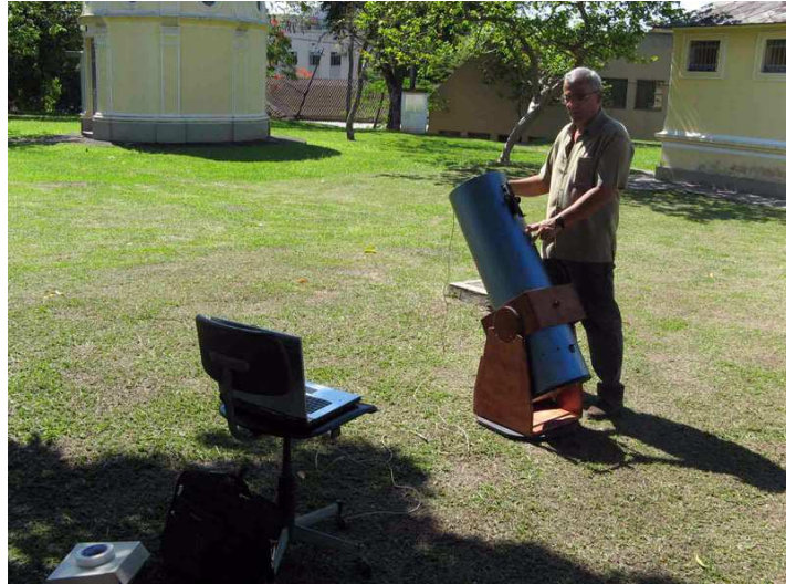
Fig. 3.21: Sessão teste de aquisição de imagens heliométricas do Sol, em 24 de novembro de 2006. O notebook próximo ao telescópio armazenava as imagens.
