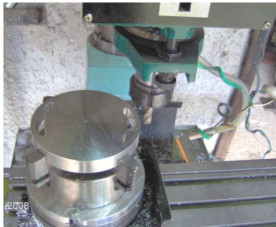
Fig. A-IV.9: Rasgos curvos abertos na peça.
