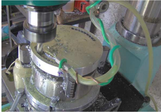
Fig. A-IV.8: Fresagem dos rasgos curvos.
