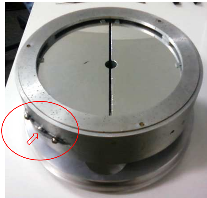
Fig. 4.47: Espelho Heliométrico completamente montado dentro de sua célula, já presa à base de colimação. Destaque para a placa metálica flexível forçando o pino móvel horizontalmente.
