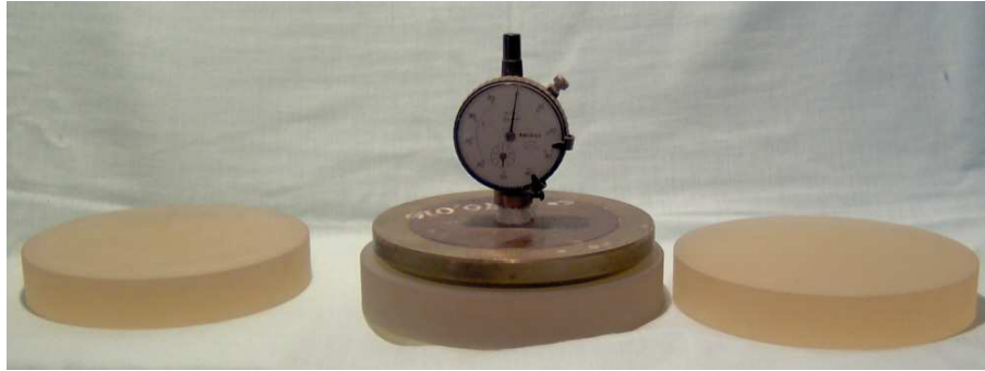
Fig. A-III.3: Esferômetro medindo a marca-zero de curvatura em um dos discos.
